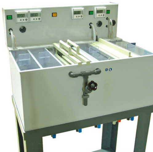
Protoc CH und Protoc SN für organische Schutzschichten (OSP) oder Oberflächenschutz mit chemisch abgeschiedenem Zinn
