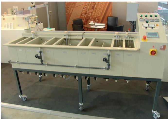
Galvanikanlage zur dekorativen oder funktionellen Oberflächenbehandlung mit Handlingsystem und SPS-Steuerung
