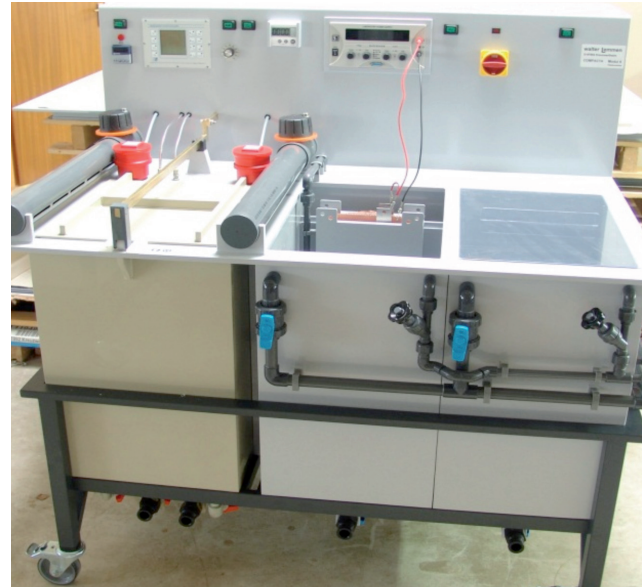
Kleingalvananlage für die Palladiumabscheidung mit integrierter Elektrolysezelle
