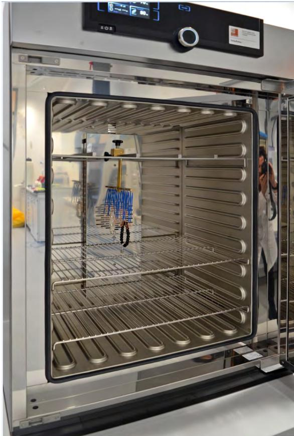
Der Umluftofen U-Serie ist ein Wärmeschrank für den universellen Einsatz im Labor.
