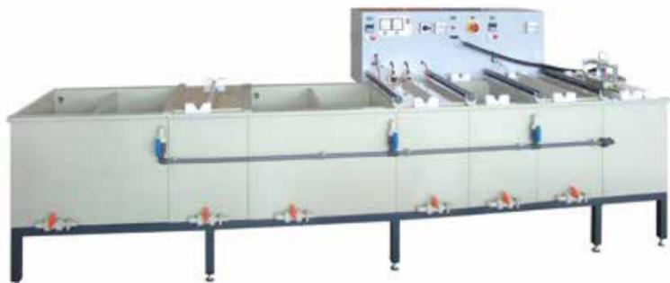
Die Anlagen zum Anodisieren von Leichtmetallen, dienen der Oberflächenbearbeitung von Teilen aus Reintitan oder Titanlegierungen und Aluminium. Die Anlage beinhaltet sämtliche Vorbehandlungs- und Nachbehandlungsprozesse für eine optimale anodische Oxidation zur Erzeugung von festhaftenden Oberflächenschichten in dekorativen Farben.
