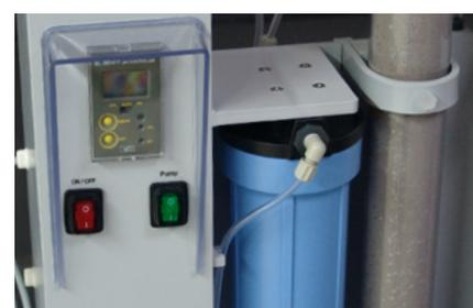
Abb.: Leitwertmessung, digital
