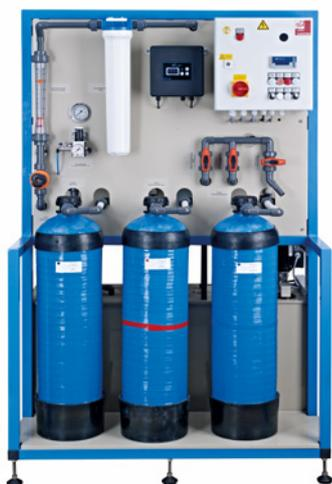
Die Kreislaufführung von Spülwässern erhält in der Oberflächentechnik immer stärkeren Zuspruch. Aufgrund der Tatsache, dass Wasser sowohl als Rohstoff als auch aus betriebswirtschaftlicher Sicht als Betriebsmittel immer wertvoller wird, ist die Aufbereitung von Spülwasser über Ionenaustauscher eine sinnvolle Investition. Bei dem abwasserfreien Verfahren wird kein Schmutzwasser in die Kanalisation geleitet.
