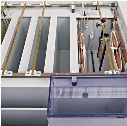
COMPACTA ist eine universell einsetzbare Serie von Galvanikanlagen für die chemische oder galvanische Abscheidung von Metallen und dient zur Produktion von durchkontaktierten Leiterplatten in Vertikaltechnik für die Prototypen- und Kleinserienfertigung.
