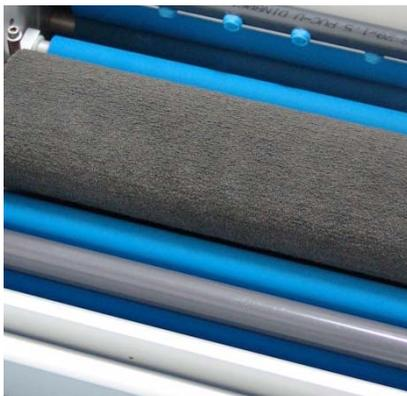
Die Bürstmaschine RBM 402 S ist als Standmodell konzipiert und wird zur Entgratung und Reinigung gebohrter Leiterplatten, zum Feinschleifen vor Fotoprozessen und zum Reinigen von Blechen eingesetzt. Das Plattenmaterial wird mit hoher Oszillationsfrequenz doppelseitig gebürstet. Die Oszillation und Einzugs geschwindigkeit sind stufenlos einstellbar. Der Bürstenabstand zur Platte ist automatisch verstellbar.
